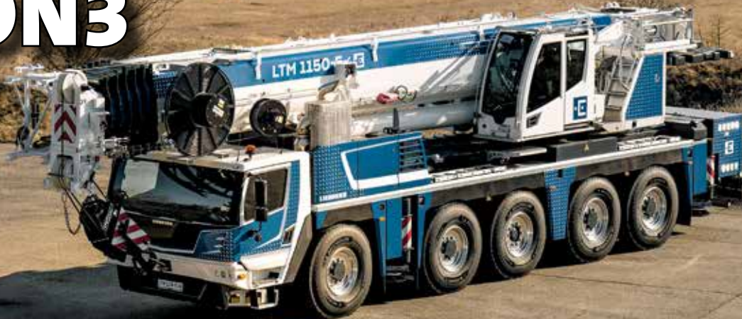
Der LTM 1150-5.4 E, die elektrisch angetriebene Variante.
