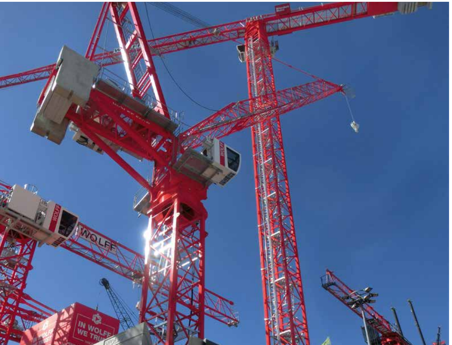
Turmdrehkrane am Wolffkran-Stand, mittig der Wolff 550 B.
