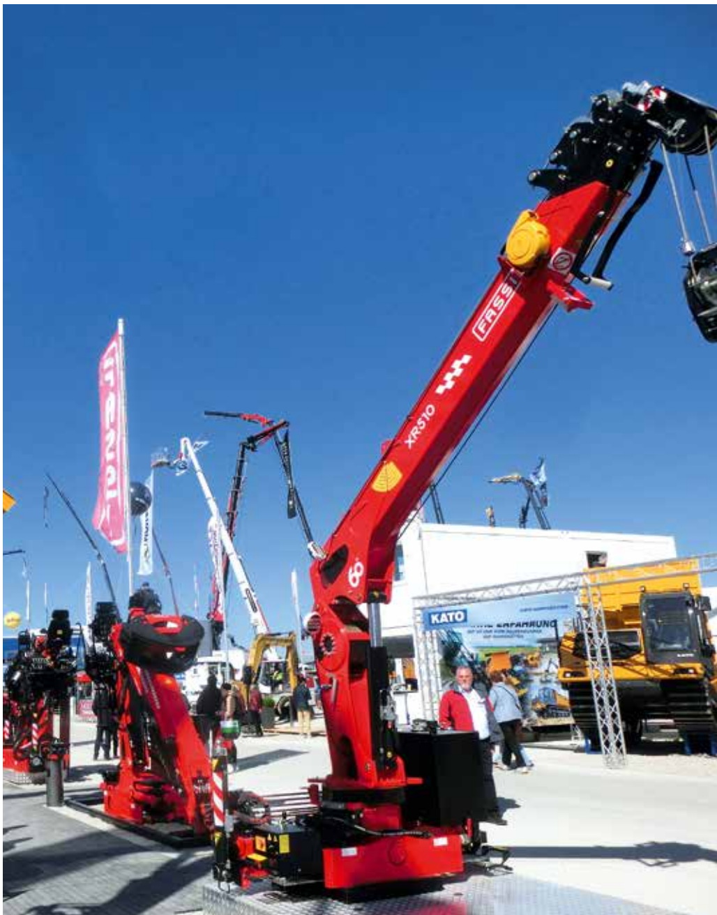
Im Vordergrund: Der neue XR510 von FASSI mit einer Hubkapazität von 5,1 t, ein neues Produkt im Bereich der starren einarmigen LKW-Krane.
