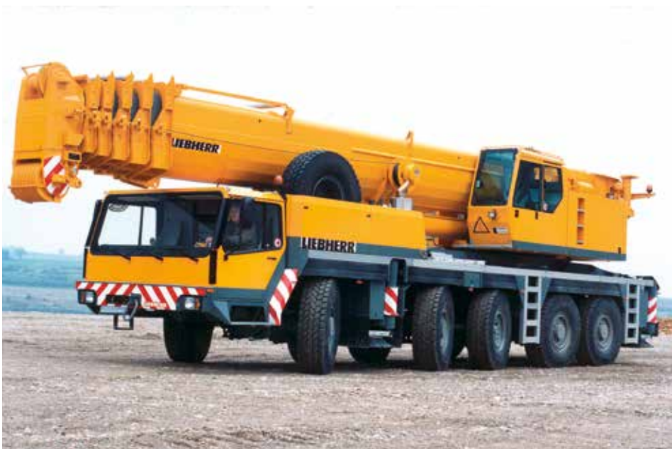
Der erste Kran, den Dr. Hamme 1994 zu konstruieren begann, war der 5-achsige LTM 1160/2 mit einem 6-teiligen 60-Meter-Ausleger.
