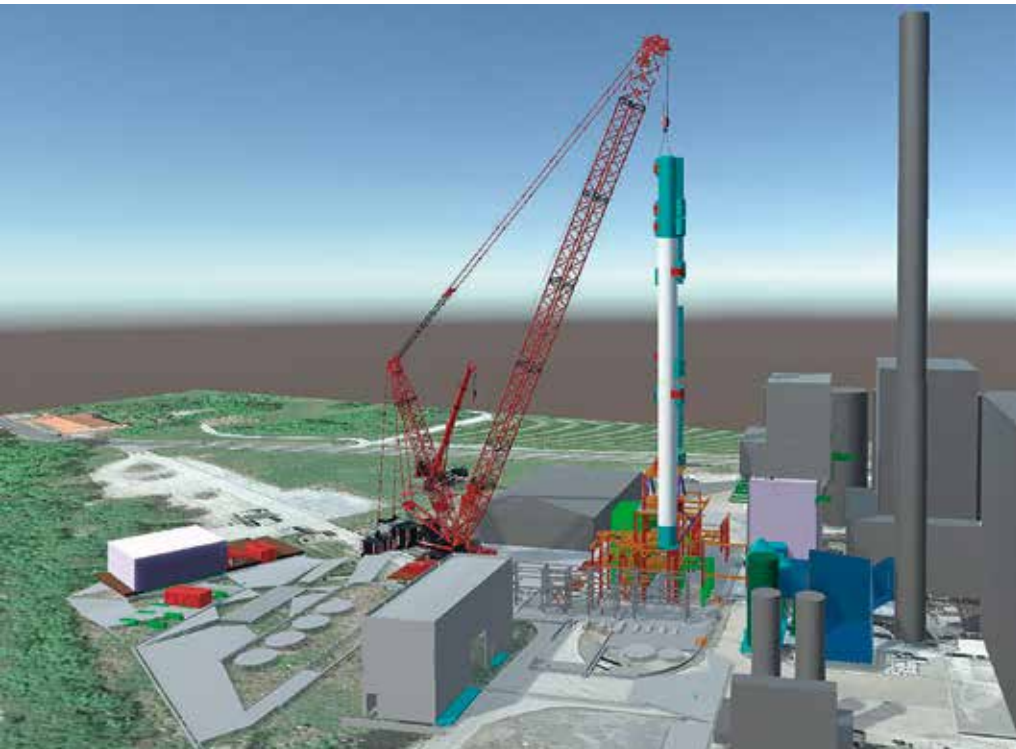
Schwerhub der Absorberkolonne für die CCU-Anlage – 3D-Engineering.
