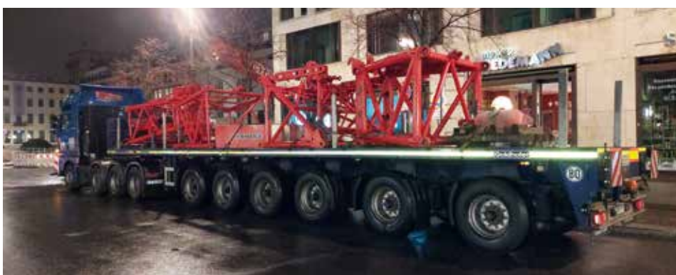
Mehrere Sattelschlepper waren im Einsatz um nur die Gittermastspitze des Krans zu transportieren.
