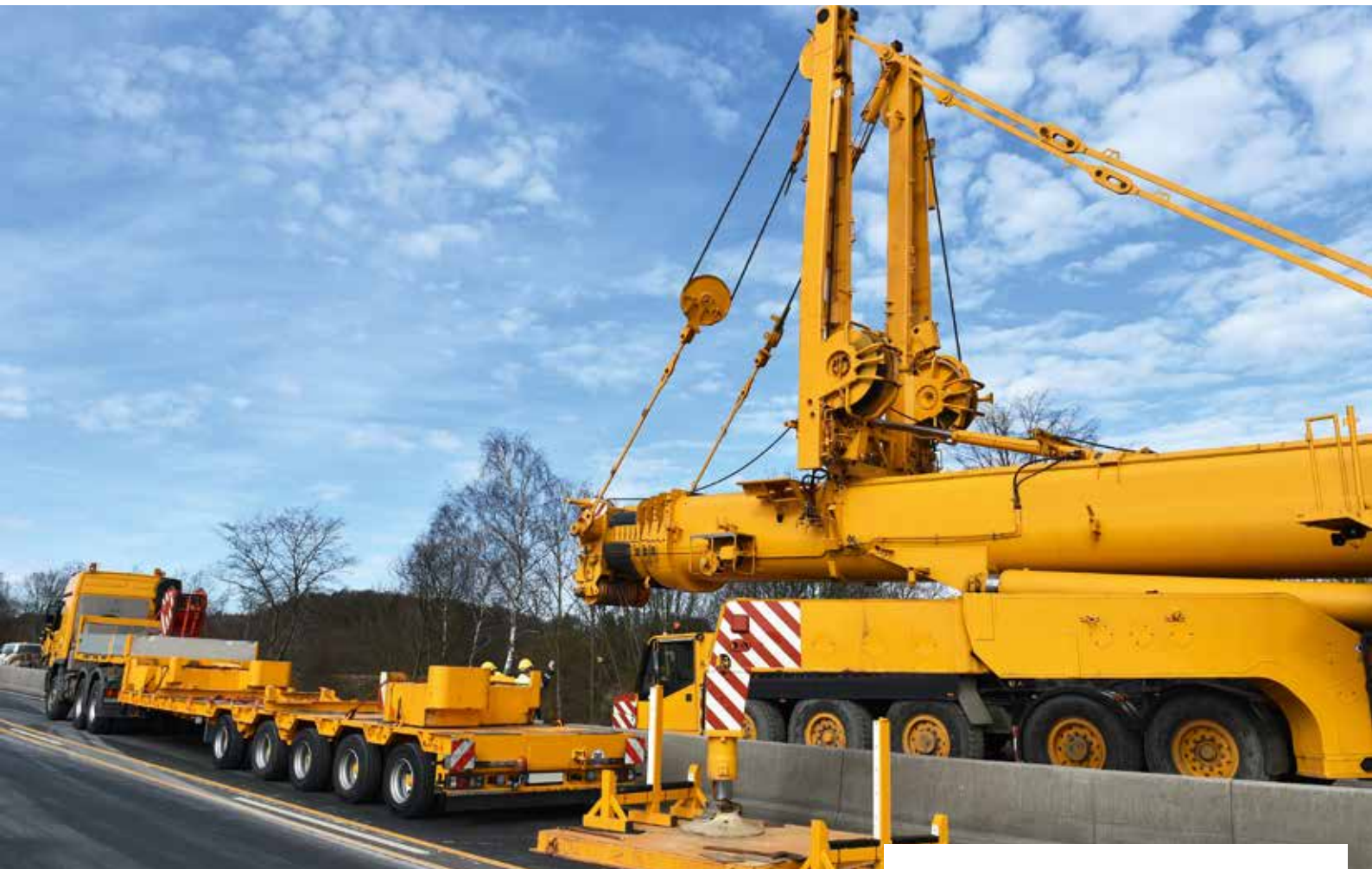
Autokrane (weil sie grundsätzlich, wie Schwerlastverkehr behandelt werden) bedürfen schon bis zu 40 Tonnen Gesamtgewicht eine Genehmigung. Bild: dieter76, stock.adobe.com
