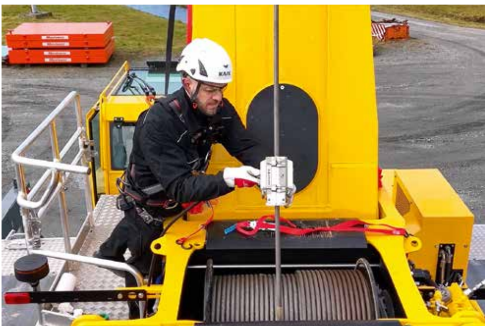
Das Seilschmiersystem in Form einer Metallhülse, wird um das Seil gespannt.
