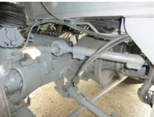
Blick hinter die Reifen auf den Antriebsstrang.
