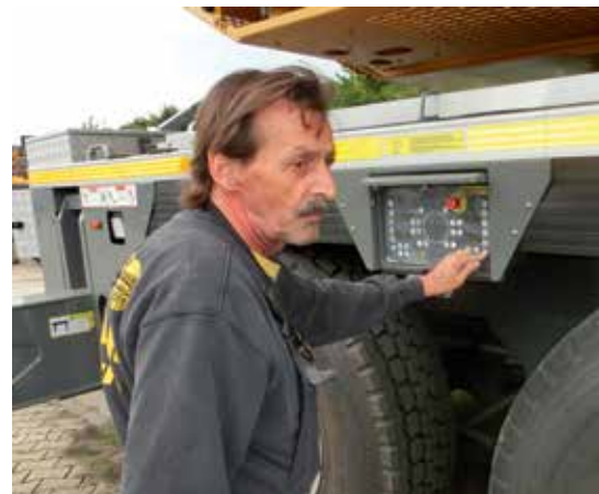
Ausfahren der Stützen.
