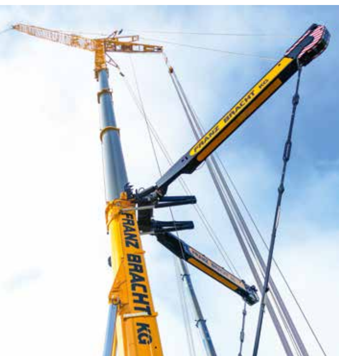
LTM 1750-9.1 in der Konfiguration TYV23EN mit 49,1 m Teleskopausleger, 20 m Gitterverlängerungen und 42 m Wippspitze.
