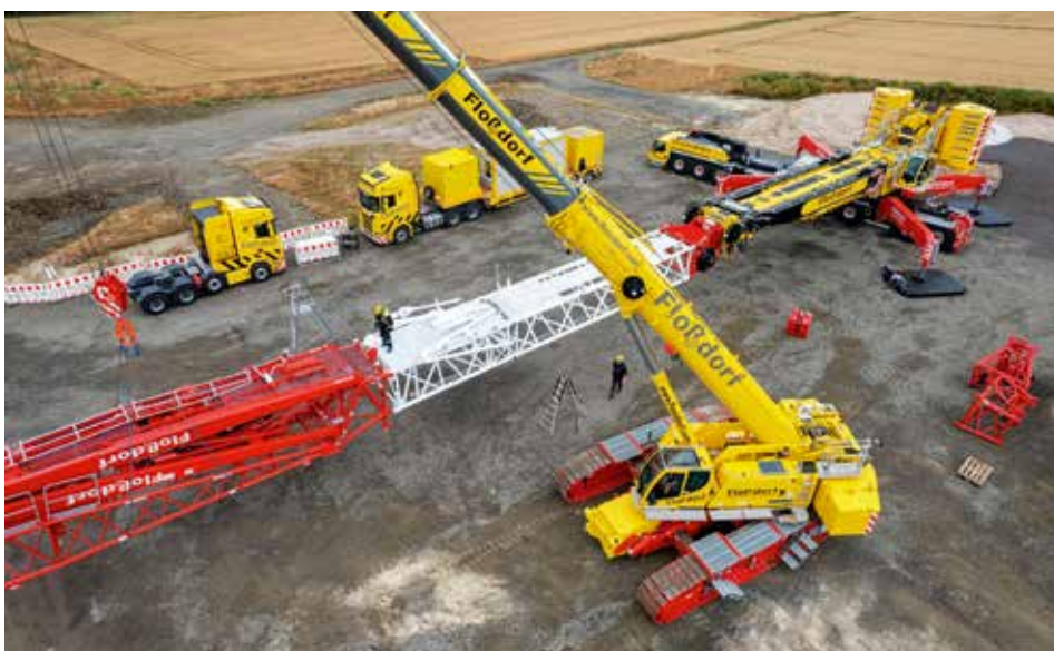
Der neue Teleskop-Raupenkran vom Typ LTR 1150 soll den LTM 1750-9.1 hauptsächlich bei Arbeiten in Windparks begleiten.
