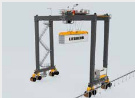
RTG-CB: elektrisch, mit festem Stromanschluss.
