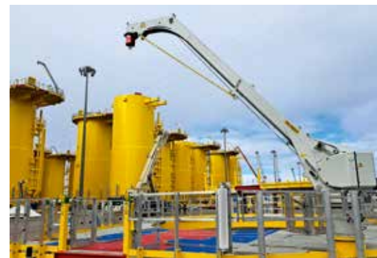
PALFINGER MARINE Plattformkran für Polens Offshore-Windpark.
