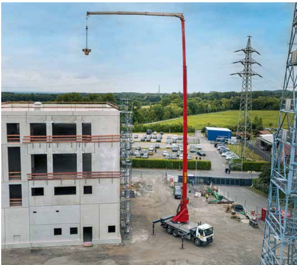
Die Turmdrehkran-Funktion des AK 48e.
