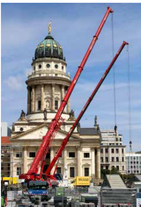
Zwei LTM der BTB-Logistik heben per Tandemhub Bühnenteile ein.
