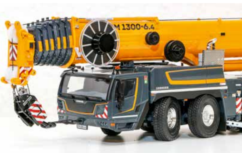
Ansicht der Unterwagenkabine und der eingefahrenen Teleskopsegmente. Gut erkennbar ist die Verbolzvorrichtung für die optionale Gitterspitze.
