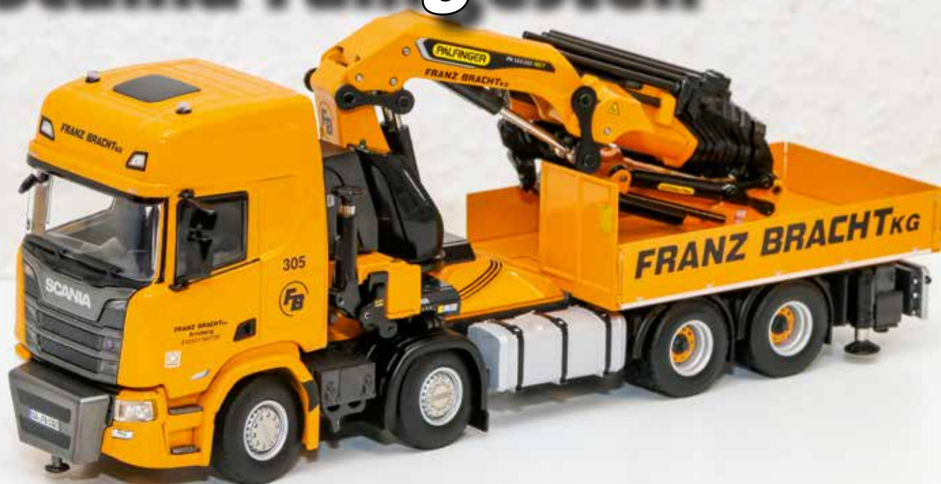
Palfinger Ladekran PK165.002 TEC7 auf Scania Fahrgestell.
