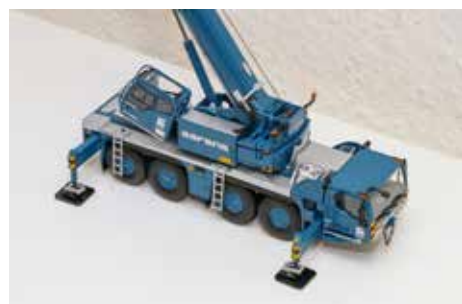
... mit ausgefahrenen Stützen, funktionalen Leitern und gekippter Kranfahrrkabine.
