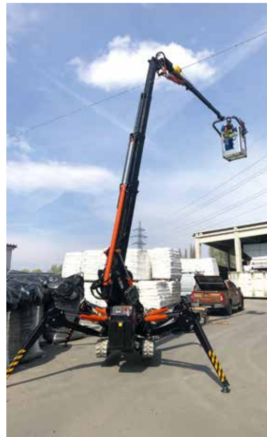
Der Mini-Raupenkrane M250 von BG Lift lässt sich mit einem Personenkorb schnell und einfach zur Arbeitsbühne umrüsten.
