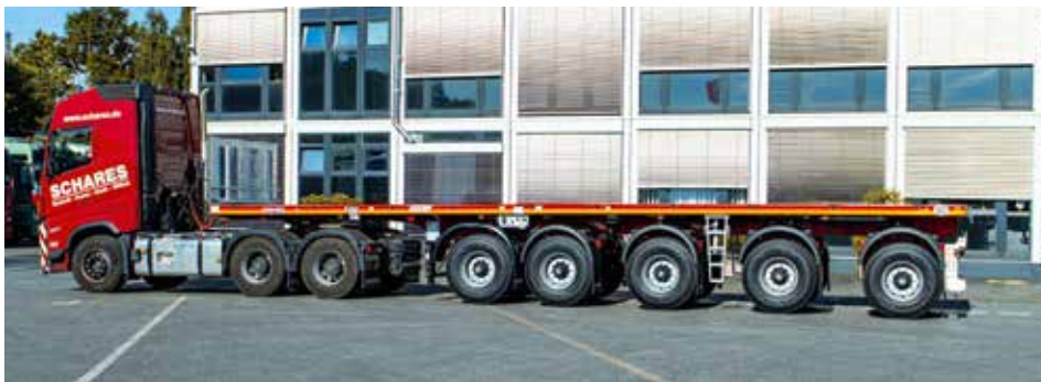
Der 5-Achs-Ballastauflieger des Typs MAX410 wurde speziell für den Transport von Kranballast entwickelt.
