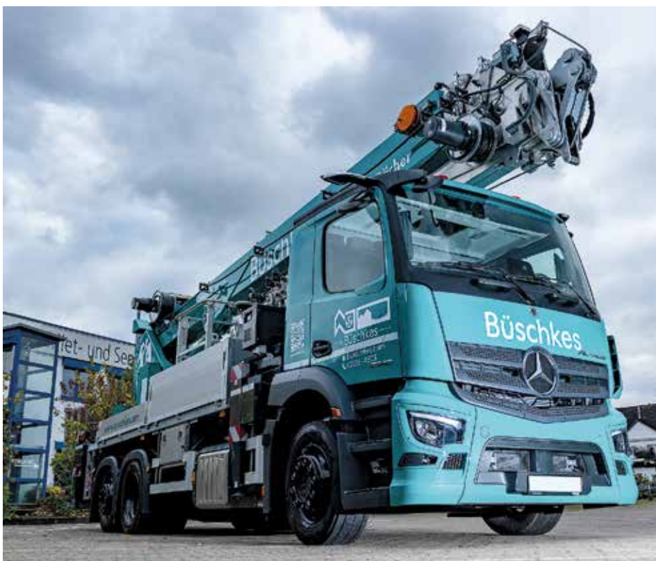
Mit einer maximalen Nutzlast bis 3 t (opt. 6 t) sowie Ausfahrlängen bis 44 m (opt. 46 m) ist der AK 46 optimal für den anspruchsvollen Baustellenalltag gerüstet.
