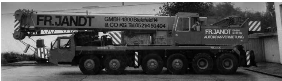
LT 1090: 90 Tonnen Tragkraft auf sechs Achsen. Heute bieten 6-achsige Mobilkrane Tragkräfte bis 400 Tonnen.
