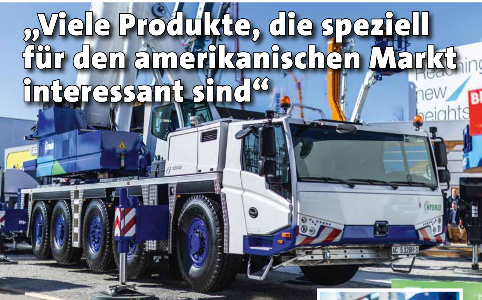
Auf der Conexpo wird Tadano mindestens auch einen AC-Mobilkran präsentieren. Im Bild der hybride 5-Achser AC 5.120H-1 auf der bauma 2025.
