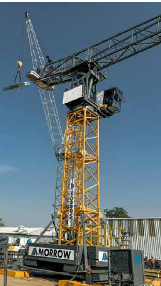
Mit der Einführung des 195 HC-LH bringt Liebherr einen leistungsstarken und hoch anpassungsfähigen Wippausleger-Kran auf den US-Markt, der speziell für die Herausforderungen dichter Städte und hoher Bauwerke entwickelt wurde.
