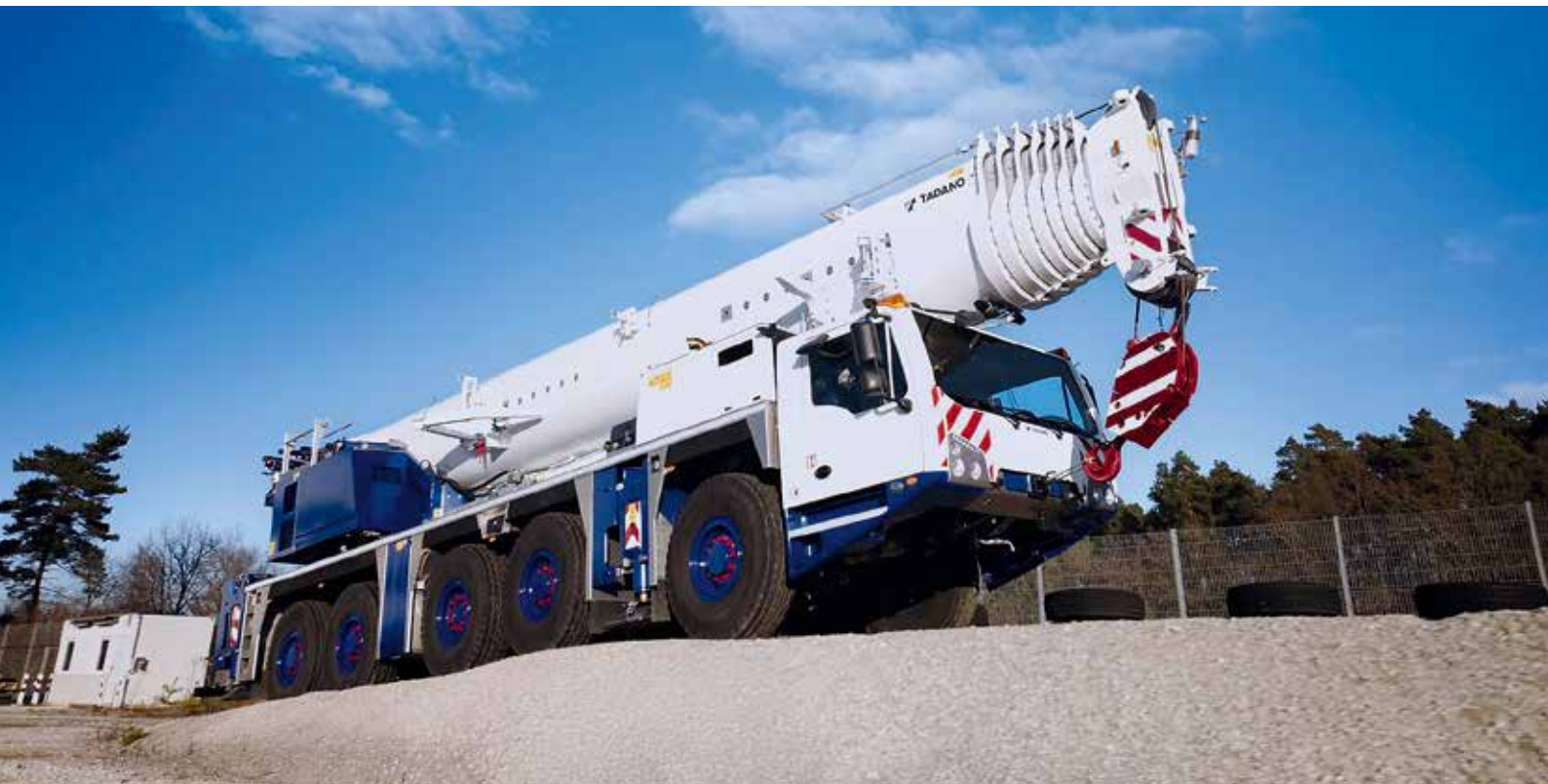
Der AC 5.250L-2 verfügt über eine straßenzugelassene Achslast, um die härtesten Standards zu erfüllen – einschließlich der Lastgrenzen in Kalifornien.
