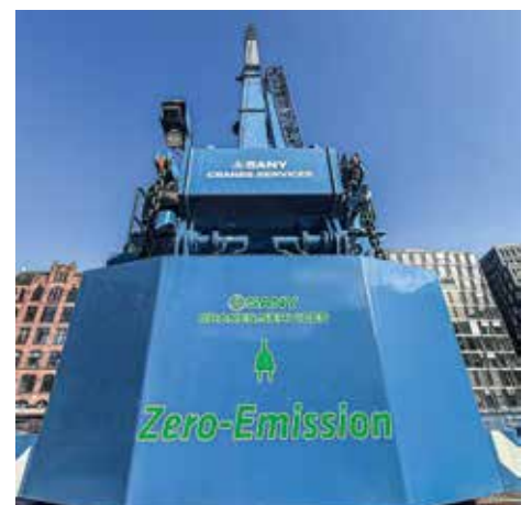
Null Emissionen: der elektrische Teleskop-Raupenkran SCE800TB-EV von SANY.
