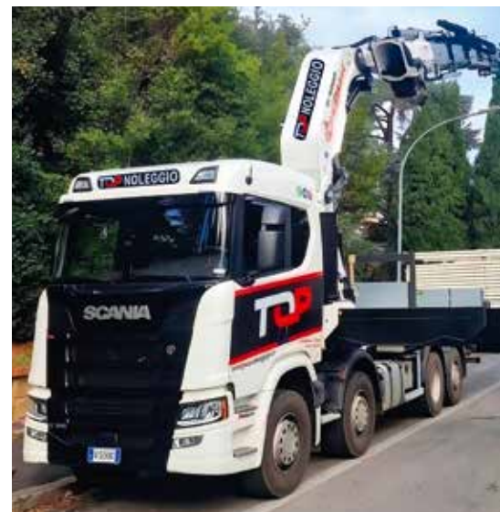
Aufgebaut ist der Ladekran auf einem Scania mit vier Achsen.
