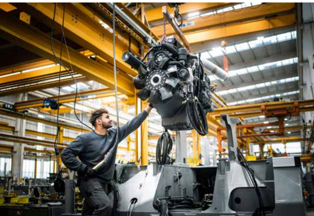
Endmontage der Liebherr-Mobilkrane: Hochzeit von Motor und Fahrwerk.
