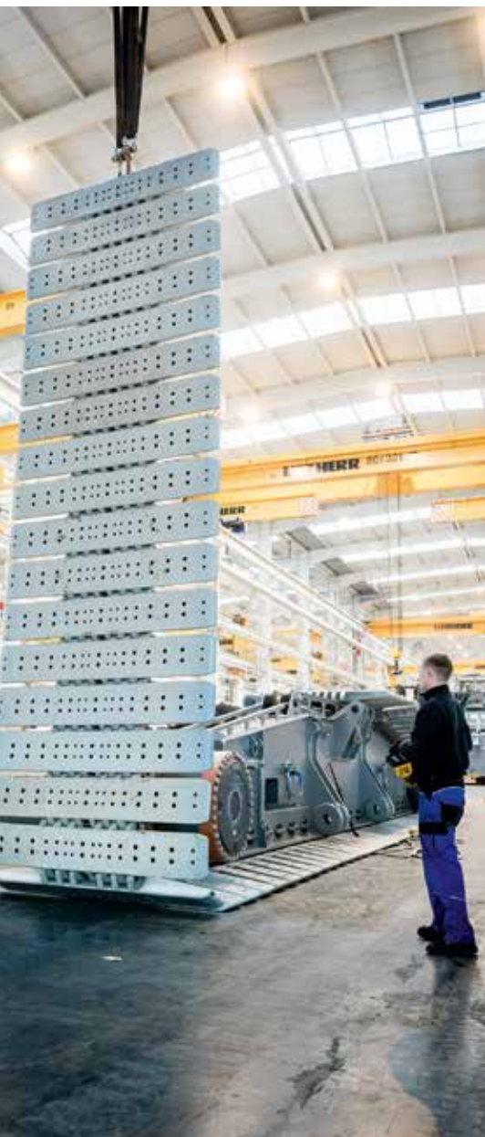
Anlegen der Kette bei einem Raupenfahrwerk.
