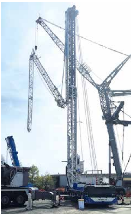
Per Knopfdruck richtet sich Liebherr Mobilbaukran MK88-4.1 selbstständig auf.
