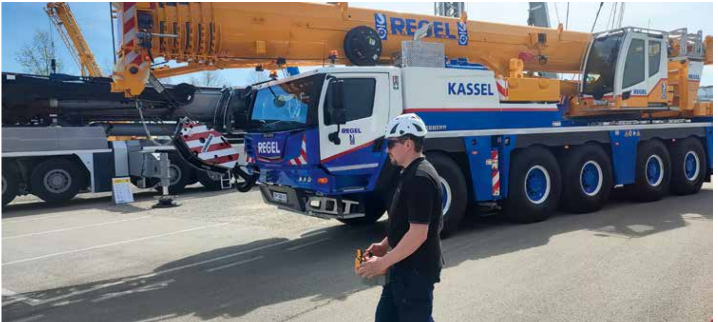
Der LTM 1100-5.3 wurde bei der Vorführung mit einer Funkfernbedienung ferngesteuert. So hat der Fahrer auf beengten ...
