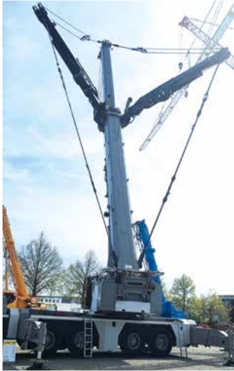
Der LTM 1400-6.1 mit fertig montierter TY-Abspannung ist zum Einsatz bereit. KM-Bild
