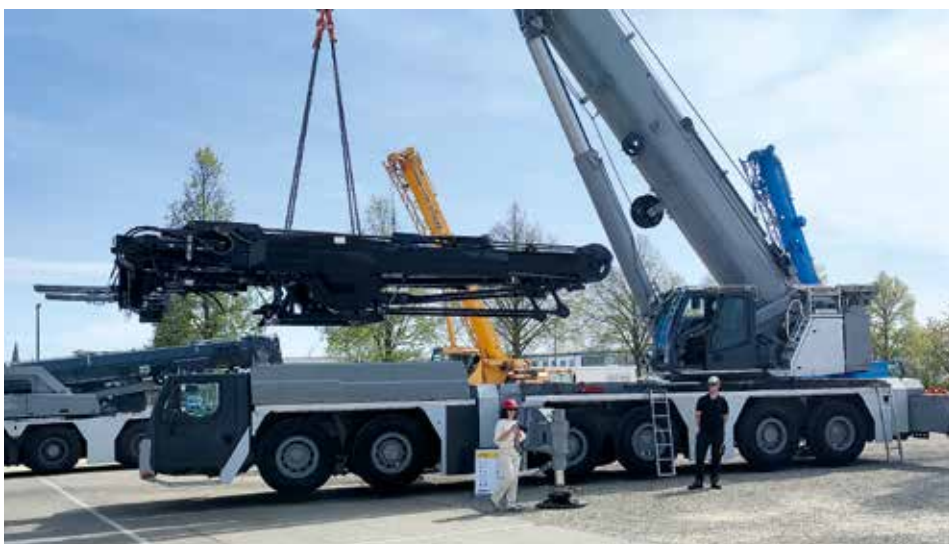
Der neue LTM 1400-6.1 bei der Selbstmontage der TY-Abspannung.
