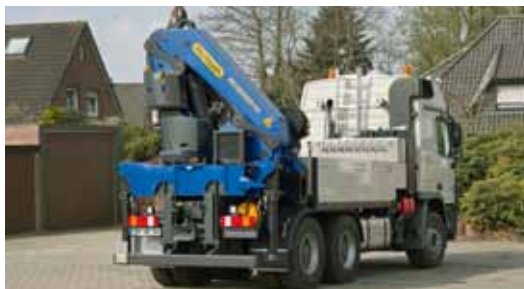
Der PK 50002 EH ist die neueste Krantechnik von Palfinger. Er ist leichter, hebt mehr und hat mehr Reichweite als sein Vorgänger. Wintershall nutzt das Kranfahrzeug auch als Zugmaschine für Tieflader.
