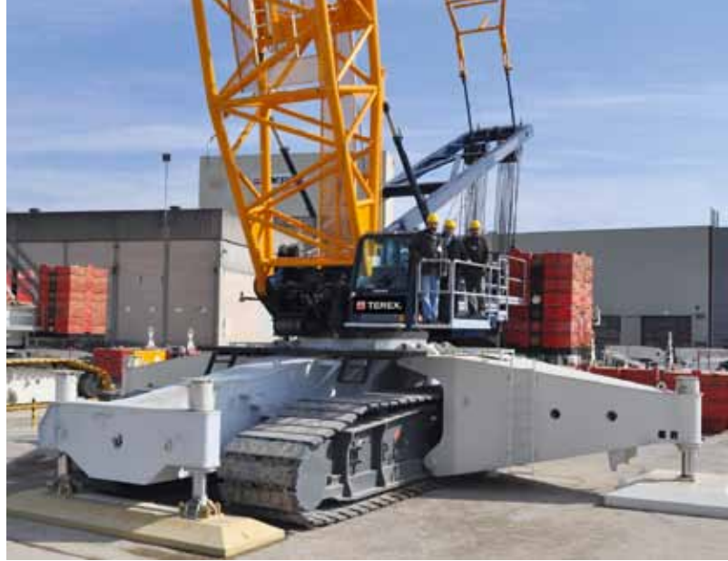
Vier Mal 600 t Tragkraft: Als echter Allrounder kommt der CC 2800 immer wieder auch an WEA zum Einsatz. Aber (Bild rechts) für Einsätze in Windparks bietet Terex auch eine Schmalspurvariante an: den CC 2800 NT. Für Einsätze, bei denen ein Gittermastkran beim Umsetzen zu einer zweiten Anlage ohnehin teilweise abgerüstet werden muss, stellt der TC 2800 eine Variante dar.
