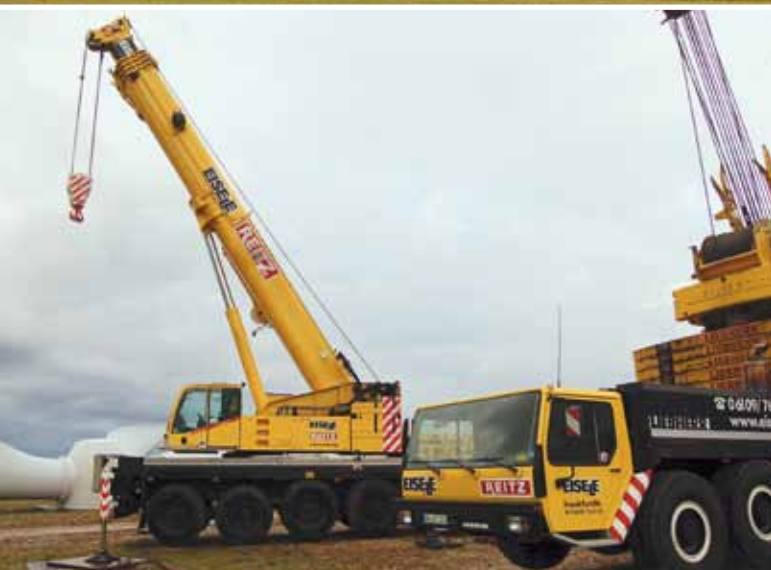
Ein 500-Tonner und sein „Gehilfe: Diese WEA ist für das Jahr 2006, dem Jahr dieses Einsatzes, nicht unbedingt repräsentativ. Der LTM 1500 kommt ohne Y-Abspannung zum Einsatz. Für eine durchschnittliche Anlage hätte 2006 schon kein Teleskopkran der 500 t-Klasse mehr ausgereicht, schon gar nicht ohne Auslegerabspannung.
