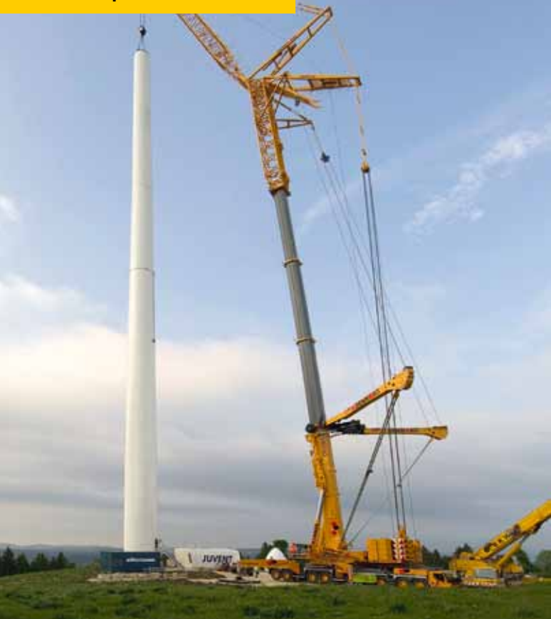
Für den 1.200 t-Teleskopkran hat Liebherr gleich zwei Varianten im Angebot: „Klassisch“ auf einem 9-achsigen AT-Fahrgestell und auf einem ultraschmalen Raupenfahrwerk. Die Tragkräfte am Teleskopausleger mit Windkraftausstattung reicht aus die Gondeln von 2 bis 3 MW-Anlagen zu heben.
