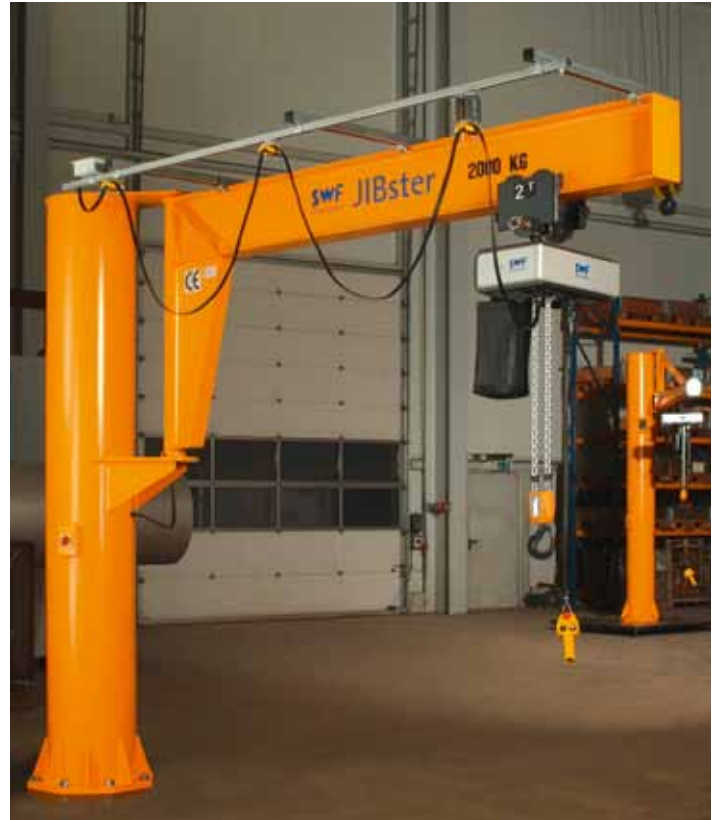
Mit den Schwenkkränen JIBster bietet SWF je nach Einsatzzweck Arbeitsplatzkrane für Traglasten bis zu 2.000 kg an.
