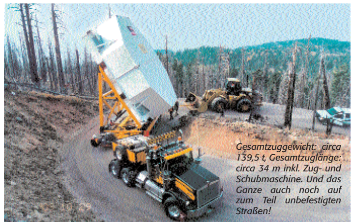
Fahrt mit 10 Millionen Dollar teurem Transportgut (im Bild die Spiegelzelle) – da wurde nichts, aber auch nichts dem Zufall überlassen, deshalb wurde zuvor die Fahrt schon mal mit einem Dummy geplant
