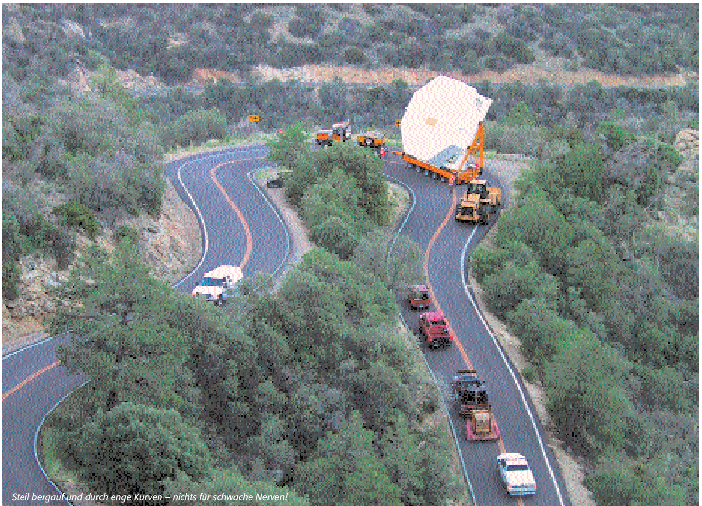
Gesamtzuggewicht: circa 139,5 t, Gesamtzuglänge: circa 34 m inkl. Zug- und Schubmaschine. Und das Ganze auch noch auf zum Teil unbefestigten Straßen!
