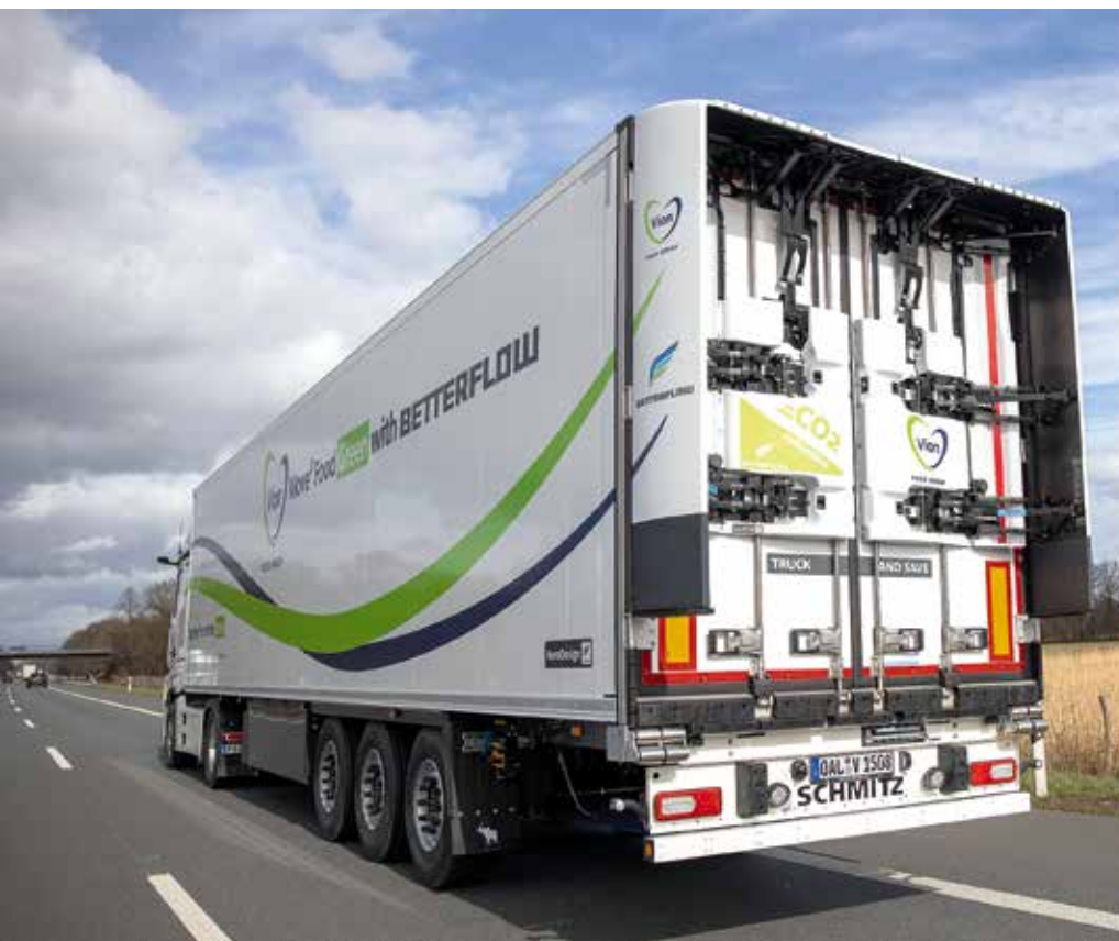
Betterflow-Aeropaket am Kühlkoffer von Schmitz Cargobull spart auf der Langstrecke.
