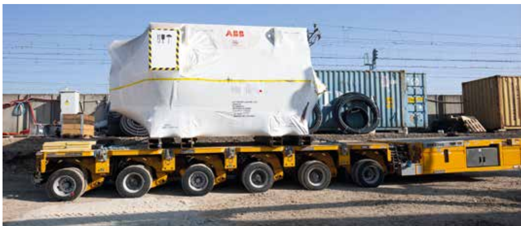
Vor der Einbringung wurden die Generatoren/Gasturbinen auf Selbstfahrer (SPMTs) umgeladen ...
