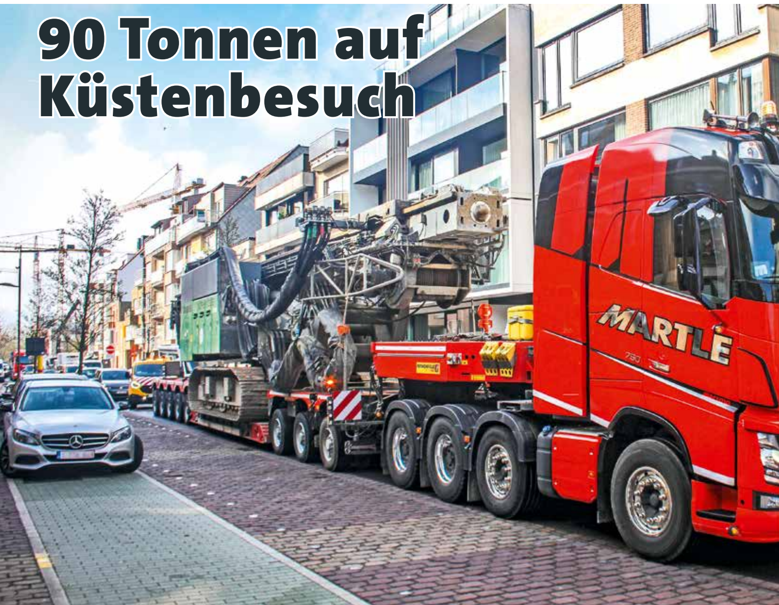
Ein 90 Tonnen schweres Ramm- und Bohrgerät ...
