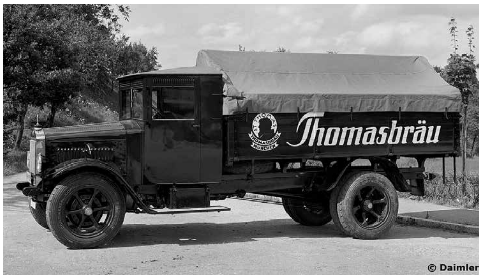
Mercedes-Benz L5 Lkw mit Motor OM5 ab 1927.
