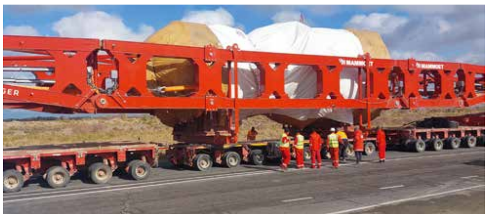
Zum Überfahren von Brücken mussten immer wieder 2 zusätzliche 8-Achs-Trailer unter die Kesselbrücke geschoben werden.
