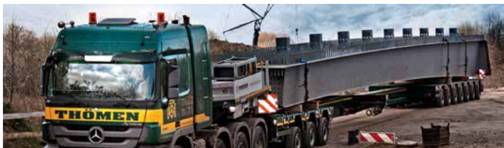
Thömen transportiert mit einem teleskopierbaren Tieflader eine Brücke.
