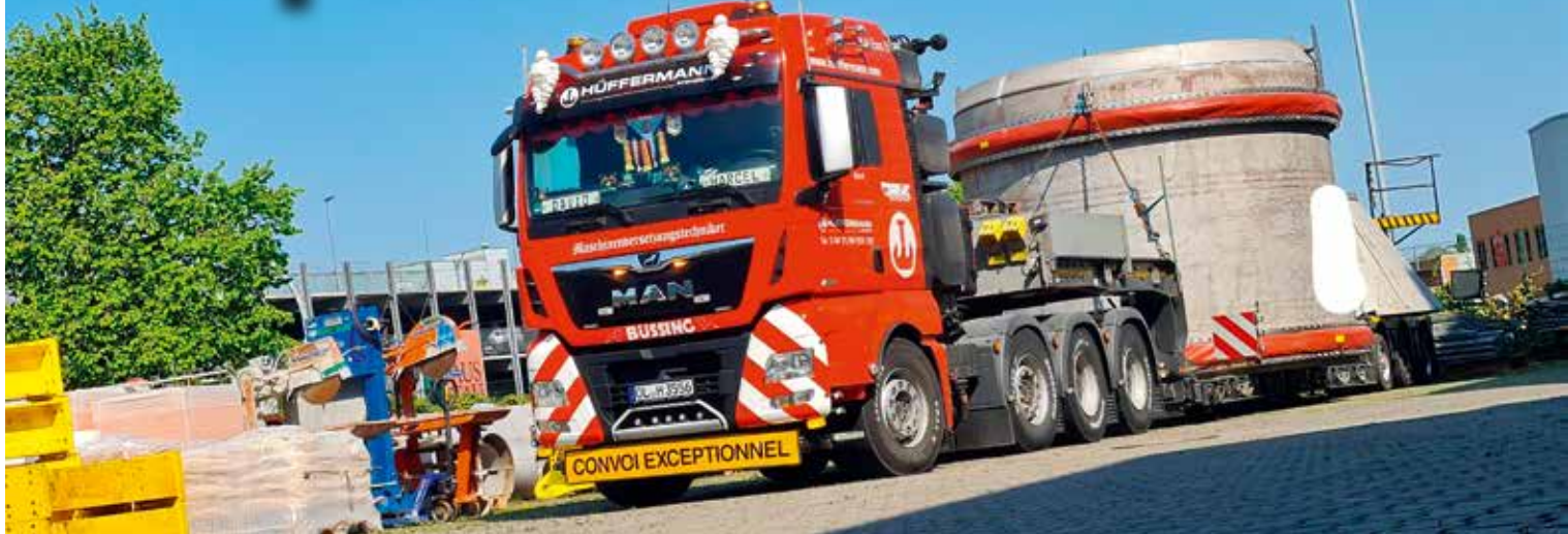
Ein Hüffermann 3-Achs-Tiefbett transportiert ein großes, schweres Betonteil.
