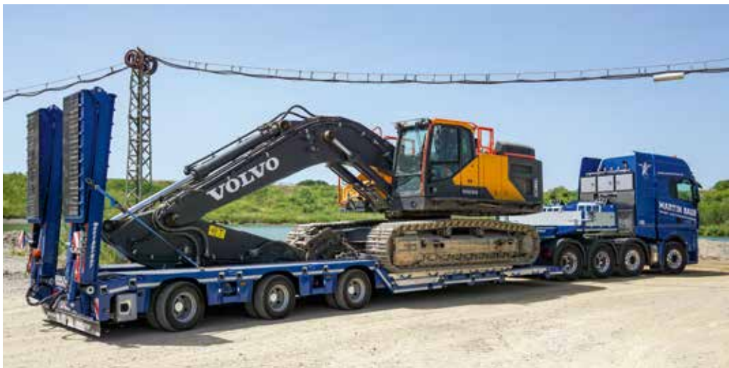
Beim Transport des Raupenbaggers werden keine Radmulden benötigt und sind komplett abgedeckt.
