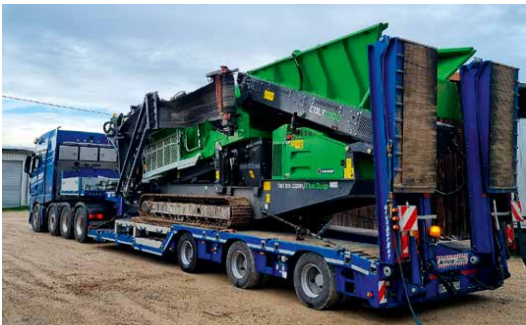
Die hintere Ladefläche wird mithilfe von Abdeckungen über dem Tiefbett verlängert.
