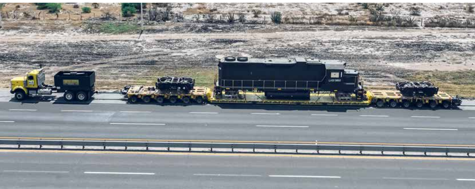
Flott ging es auf der 12-achsigen Schwerlastkombination THP/SL über die mexikanischen Highways.
