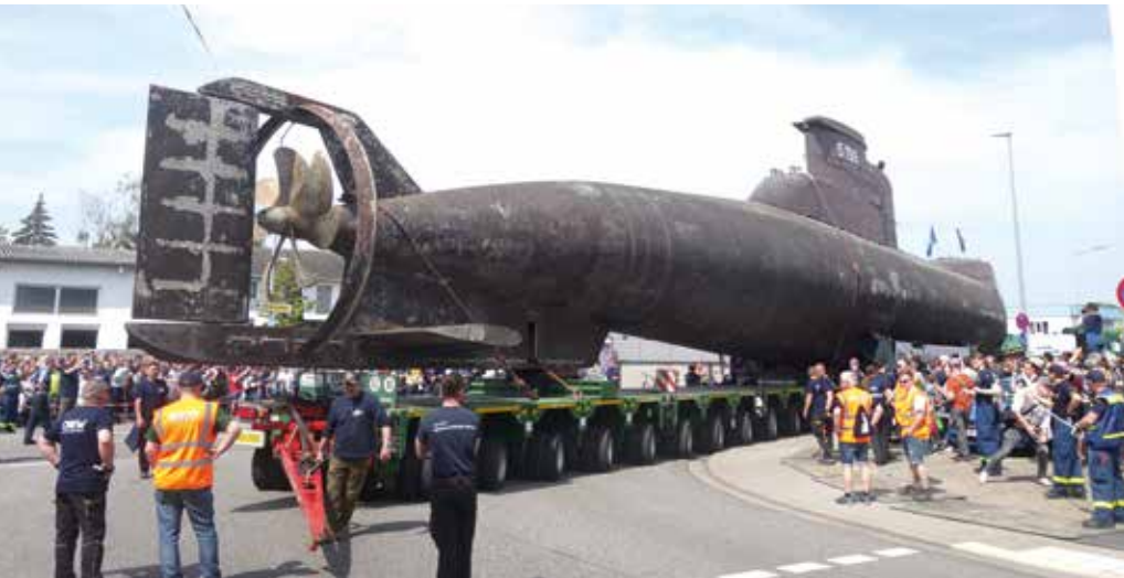
Nachdem es mit U17 erstmal an der Heinkelstraße vorbeiging, wurde auch die zweite hintere Zugmaschine abgekoppelt, um dann anschließend rückwärts in die Heinkelstraße zu stoßen. STM-Bild
