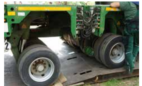
Der Achsausgleich der Pendelachsen von bis zu 650 mm hält die InterCombi-Plattform in Waage. STM-Bild
