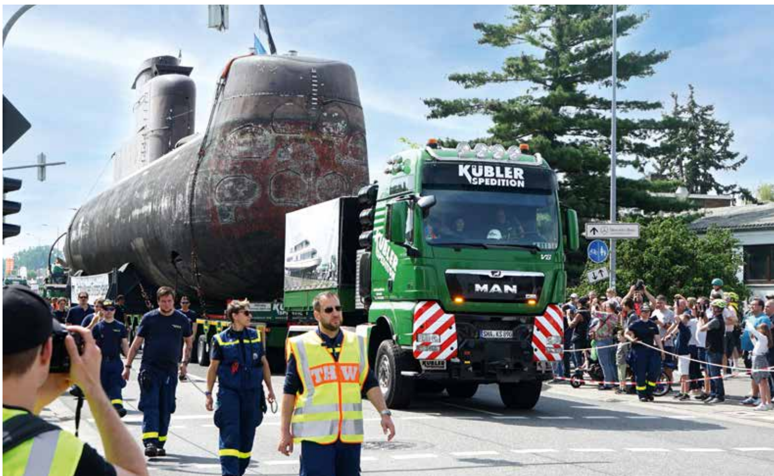
Der Kreuzungsbereich Industrie-/Heinkelstraße ist erreicht. Für das anstehende Manöver wurden sowohl vorne als auch hinten jeweils eine Zugmaschine abgekoppelt.
