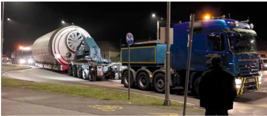
Transport einer Anlage mit einer Länge von 22 m und einem Durchmesser von 5,2 Meter nach Ungarn. Frachtführer: Dan Czech Specialtransport sro.
