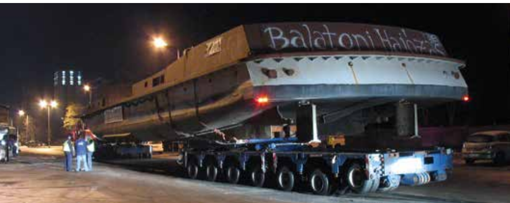
Transport eines Schiffkörpers mit einer Länge von 43 Meter, einer Breite von 7,4 Meter zum Balaton (Plattensee). Frachtführer: OVIT Zrt.
