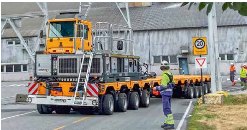
Eine kompakte Bauweise wurde durch die Positionierung des Power-Packs und der Fahrerkabine auf dem Vier-Achs-Modul realisiert.
