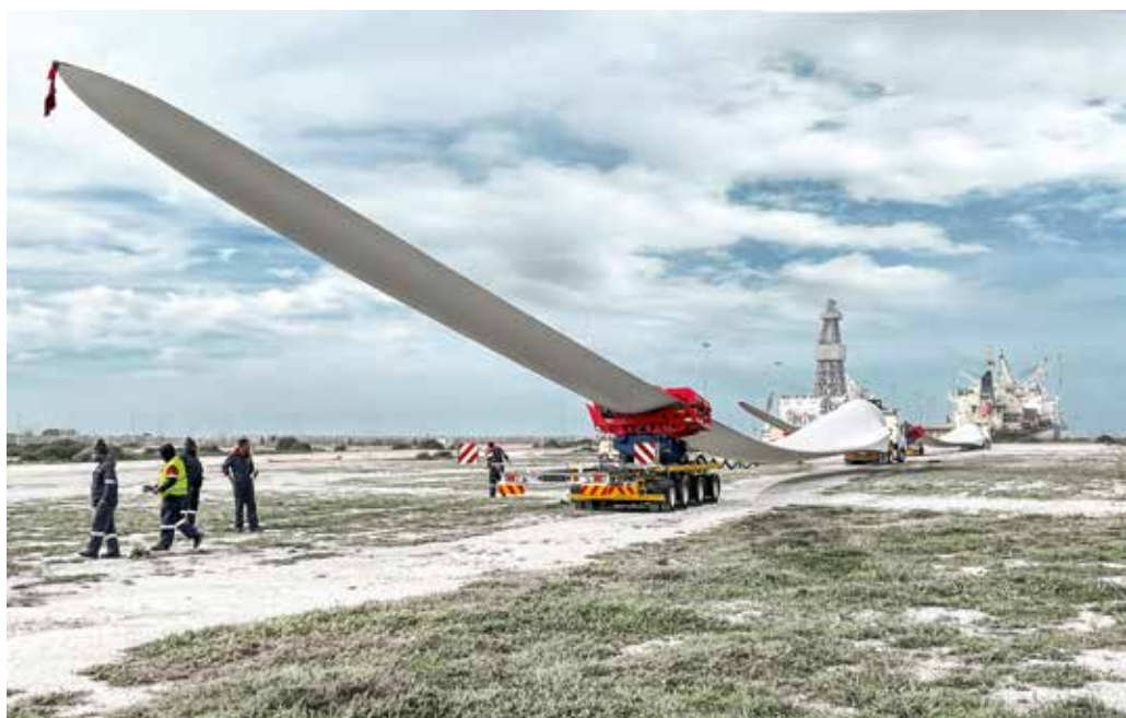
Im Konvoi: zwei TII SCHEUERLE RBTS jeweils bestückt mit einem 83 m langen Rotorblatt.
