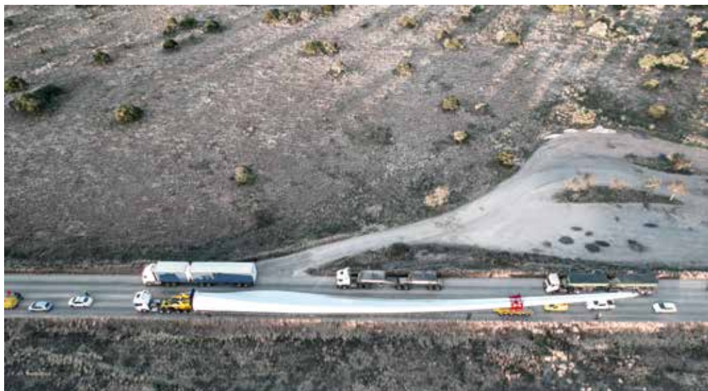
Rotorblatttransport auf ebener, gerader Strecke
