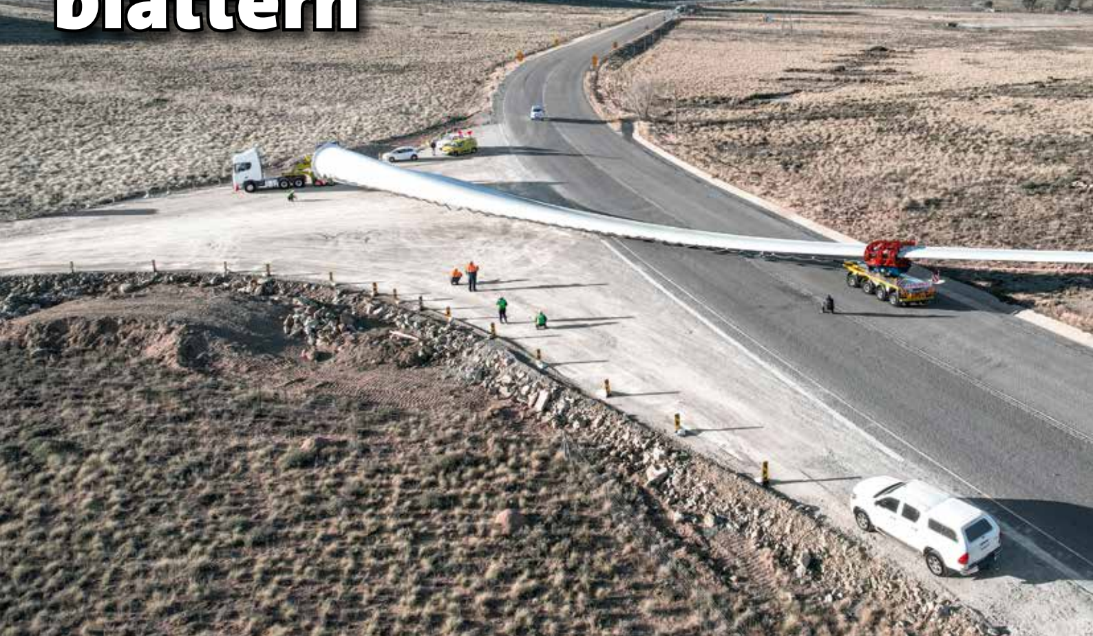
Problemlose Kurvenfahrt mit den RBTS-Transportsystem.
