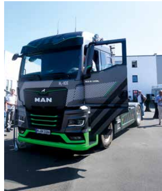
Der MAN TGX 18.520H2 ist mit einem Wasserstoffverbrennungsmotor ausgestattet. STM-Bild
