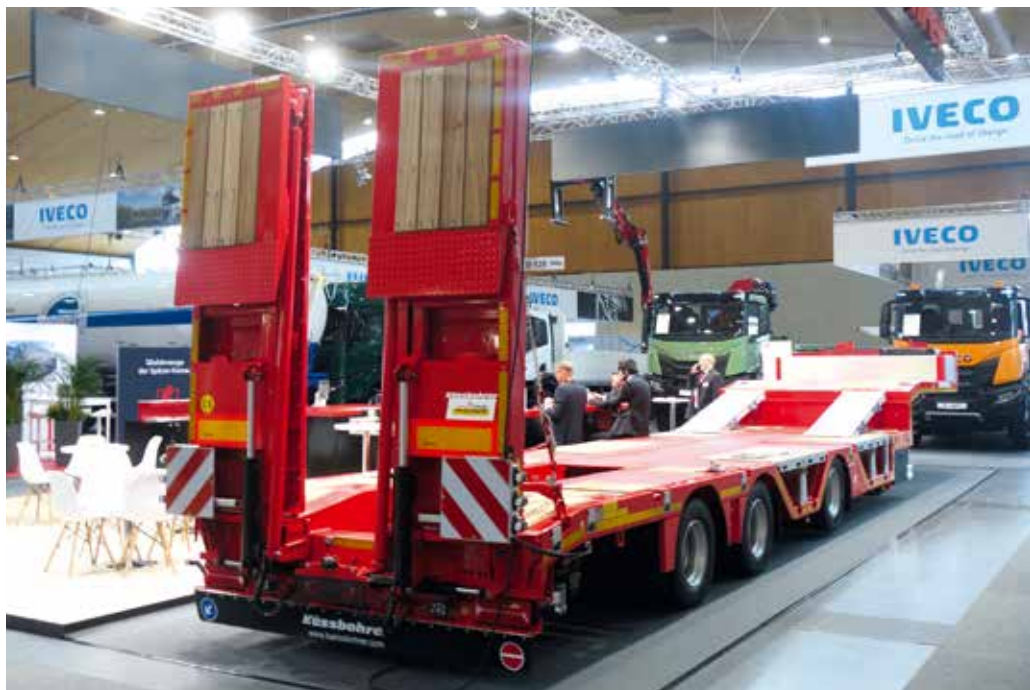
Der gezeigte teleskopierbare Tiefbettaufleger vom Typ K.SLA 3 mit drei Achsen war ferner mit Radmulden ausgestattet.
