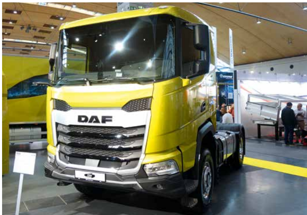
DAF XFC 530 FT PXP mit hydrostatischem Vorderradantrieb, entwickelt zusammen mit der Firma Paul Nutzfahrzeuge GmbH in Vilshofen, im Baustelleneinsatz.
