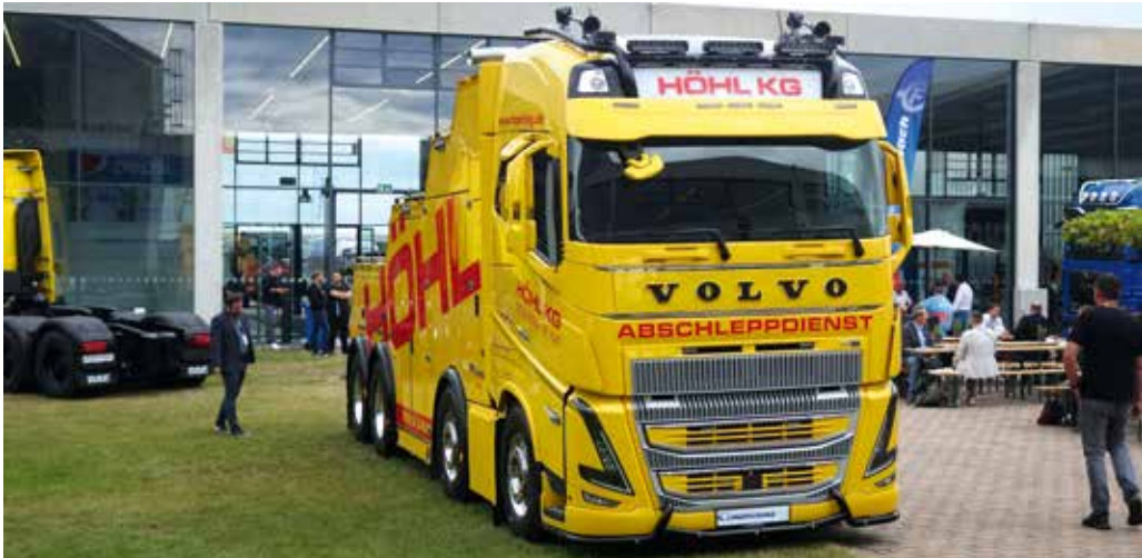
Im Atrium zwischen den Messehallen war diese Sonderanfertigung des Volvo FH16 mit 750 PS als Abschlepp- und Bergfahrzeug für die Höhl KG zu sehen. STM-Bild
