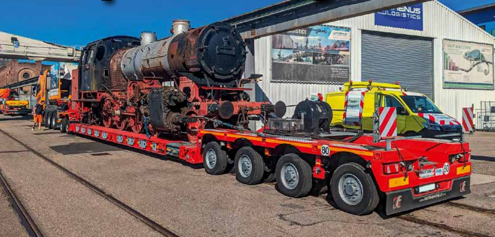
Die 60 Tonnen und 13,86 Meter lange Lokomotive auf dem 2+4 Tiefbett.
