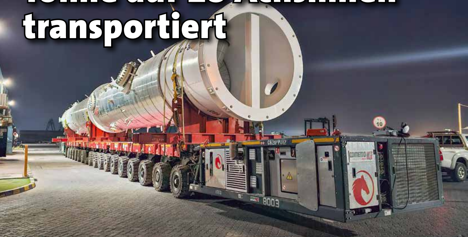
Die 18 SPMT-Achslinien von Cometto haben den 30-Meter-Absorberrtank gesattelt.
